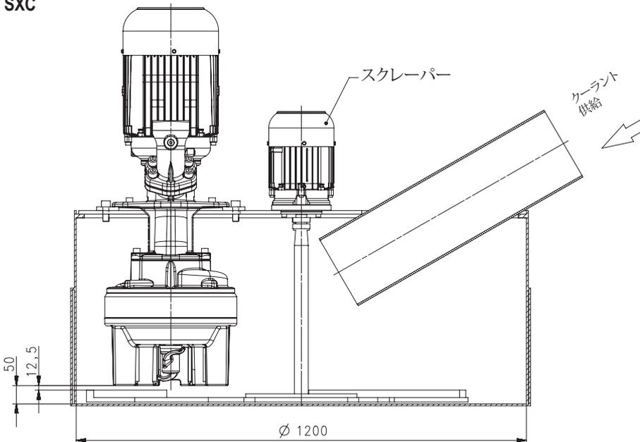
SXCシリーズのカッターポンプは、低合金スチール、機械加工スチール(SXC-H)および鋳鉄/アルミニウムの組み合わせ(SXC)などを切屑でご使用になれます。切屑は、鳥の巣状や束になった切屑も処理できます。
