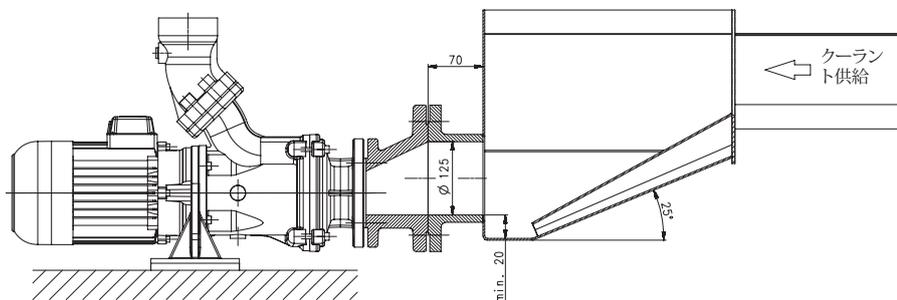
SBF型は技術的にはSFL型と類似のポンプです。SBF型は機械クーラント吐出部に直接接続でき、部品もさらに耐久性のあるものに変更可能ですし、無制限の空運転も可能です(ダブルメカニカルシール)。
