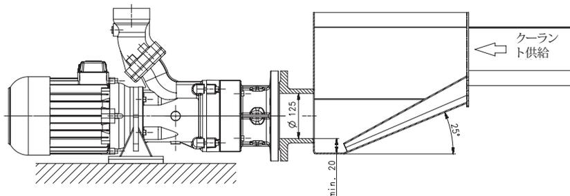
SBC型ポンプは技術的にはSFC型ポンプと類似のポンプです。タンクに搭載する場合或いは機械に直接取り付ける場合に破損した工具などの異物がポンプ吸い口に近づかないように設計上の配慮が必要です。
