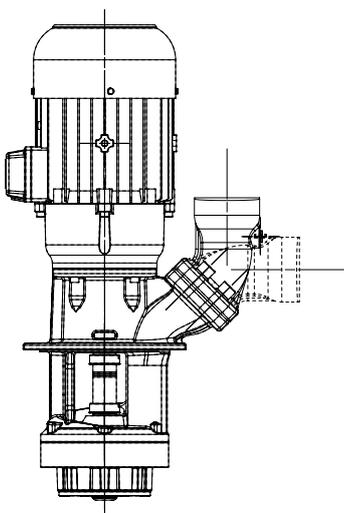
SPCシリーズのカッターポンプは比較的長く細いプラスチックの切屑を切断する為に設計されました。切断用の歯が多い為に切断周期が増え、安定的に細かく切断が出来るようになりました。
