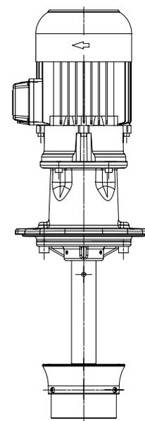
IMXミキサーは沈殿物の沈降を防ぐために、タンク内の流体を一定の循環で維持するために使用されます。ミキサーの一般的な別用途は、クーラント表面上に浮遊している研削ウールやマットの切り屑をすくい取ってほぐす為に使用されます。
