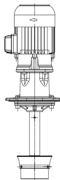
Il mixer mantiene, all'interno della vasca, un flusso costante ed evita ogni tipo di sedimentazione. Un altro impiego è quello di distruggere le spugne di rettifica che si possono fermare sulla superficie del liquido.
