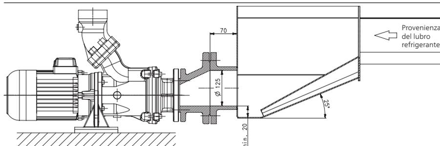
Le pompe SBF sono tecnicamente comparabili alle SFL. Queste pompe possono essere collegate direttamente al basamento della macchina. Su richiesta è possibile utilizzare materiali resistenti all'usura che permettono un illimitato funzionamento a secco (doppia tenuta ad anello scorrevole).
