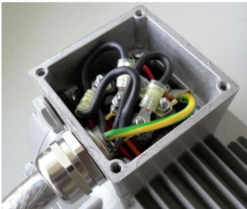
Fig. 16: Cablaggio nella cassetta di connessione motore
